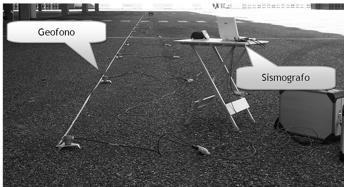
Fig. 3.7 – Esempio di acquisizione sismica in array con metodologia Re.Mi.
