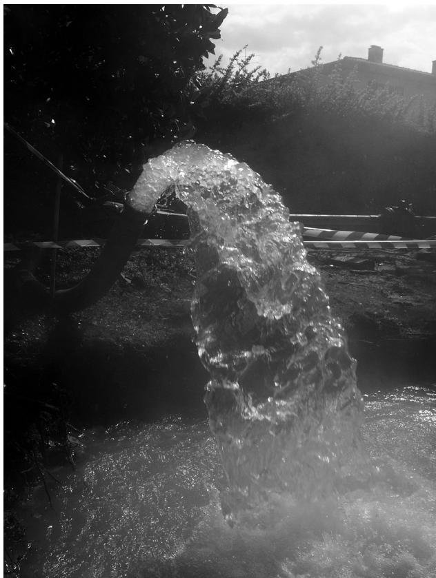
Fig. 5.23 – Produzione di acqua calda alla temperatura di 46 °C presso Domegliara (foto E. Castellaccio).
